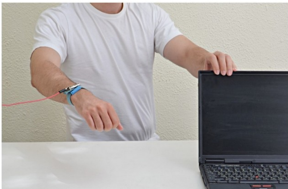
Адаптивная атака «человеческое прикосновение» с помощью голых руки. Браслет на другой руке подсоединен к измерительному проводу.
